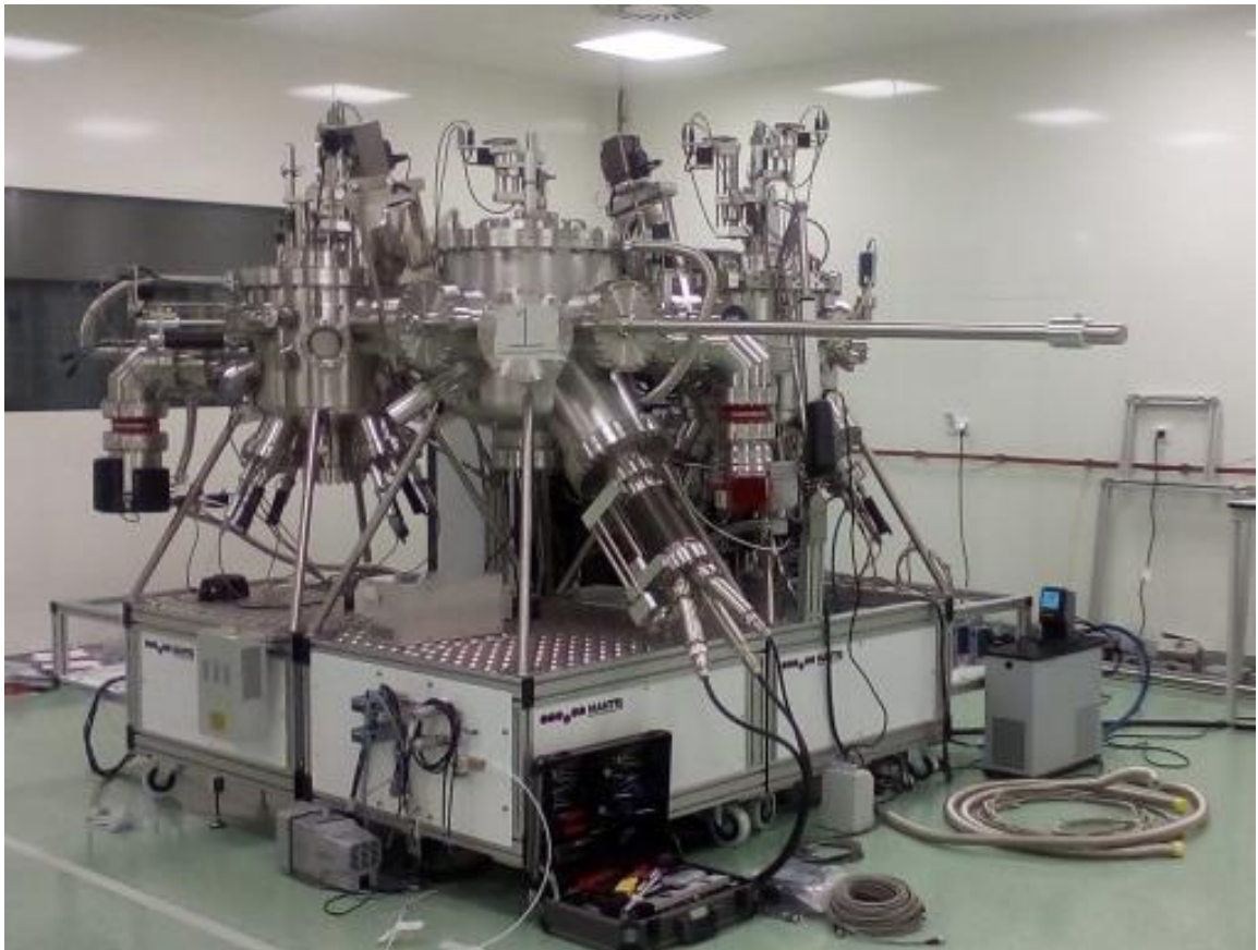
Fig. 1. Instalația tip cluster pentru fabricarea filmelor subțiri/groase prin RF/DC sputtering.
