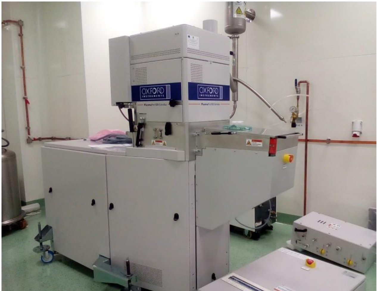
Fig. 3. Instalația pentru corodare fizică și chimică cu plasmă cuplată inductiv (RIE).
