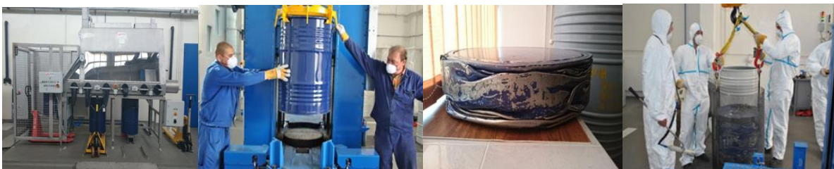
Operații pe fluxul tehnologic de supercompactare a deșeurilor radioactive solide
