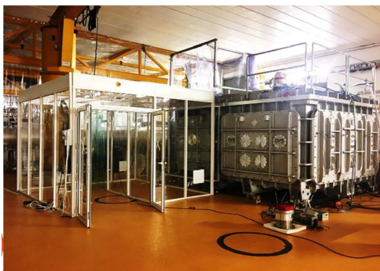
Sala experimentală E1 este dedicată experimentelor de fizică nucleară cu pulsuri laser de 10 PW.
